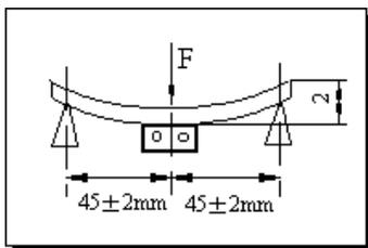
将产品按图焊在 1.6±0.2mm 的 PCB 板中间，由箭头方向施力：1mm/S，弯曲距离：2mm，保持 5±1S，产品金属层无脱落。
